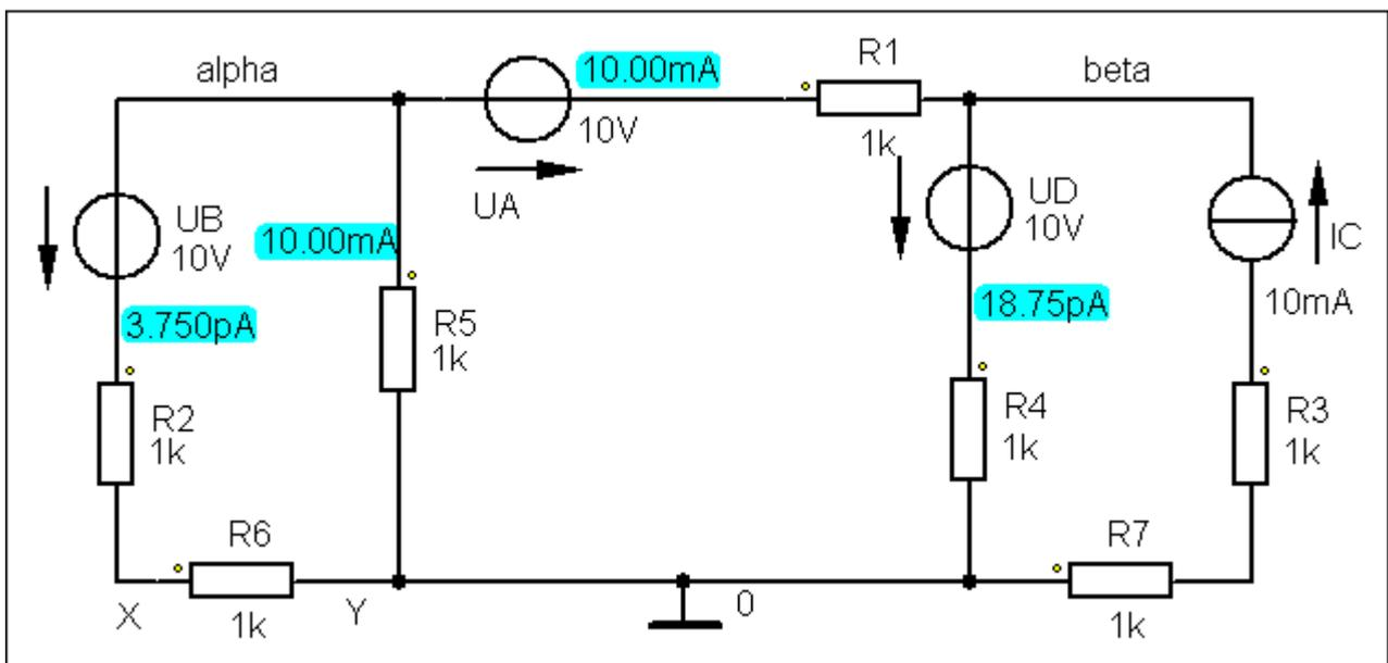
Bild ÜA\_1\_5.5.C\_2: Simulationsergebnisse mit einer DC-Analyse (Arbeitspunkt-Analyse)
