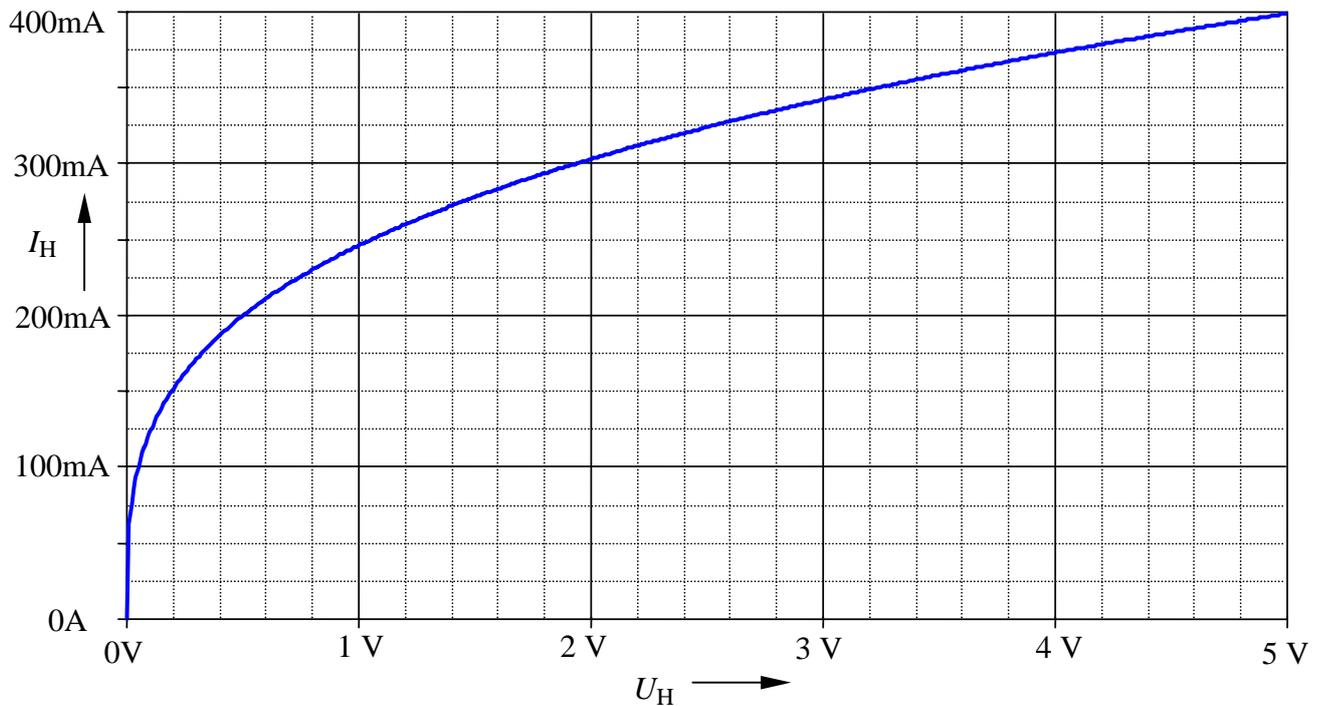
Bild ÜA\_1\_6.4.B\_2: Glühlampen-Kennlinie
