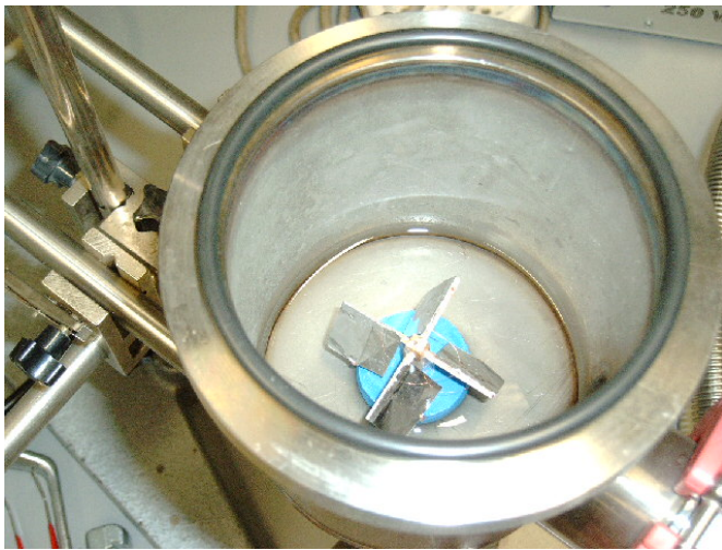
Bild 2: Vakuumkammer mit einem elektrostaten Rotor, der auf einem vakuumtauglichen Öl schwimmend gelagert ist.
