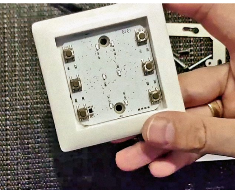
Ein Mikrocontroller mit LoRaWAN-Modul (Prototyp) empfängt die Werte der Stromquellen und steuert entsprechend die LEDs an.
