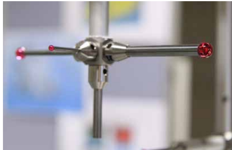
Messfühler am Koordinaten-Messgerät
