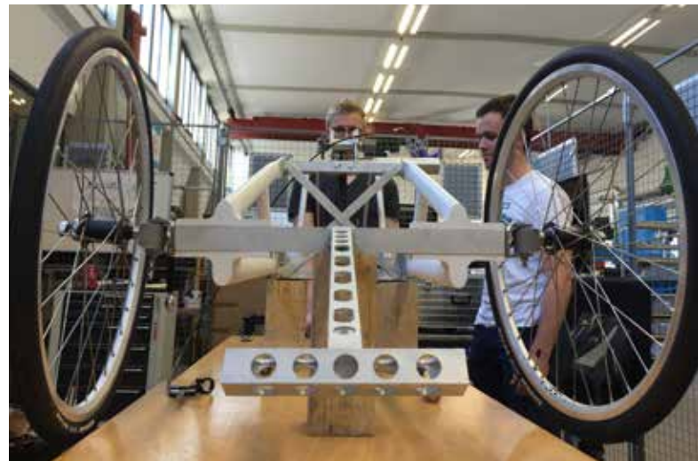
Unser „Akkurrenner“ - optimal für Studien- und Projektarbeiten. Sein Rahmen ist zum größten Teil mit einem 3D-Drucker gefertigt.
