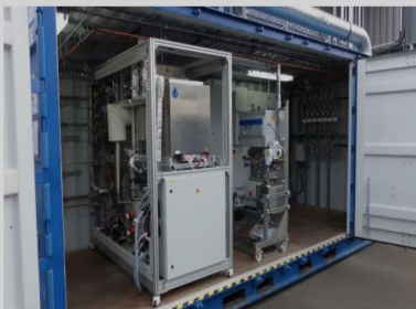
Wasserstoff-Elektrolyse: Ausgangspunkt muss grüner Strom sein • © Sunfire
