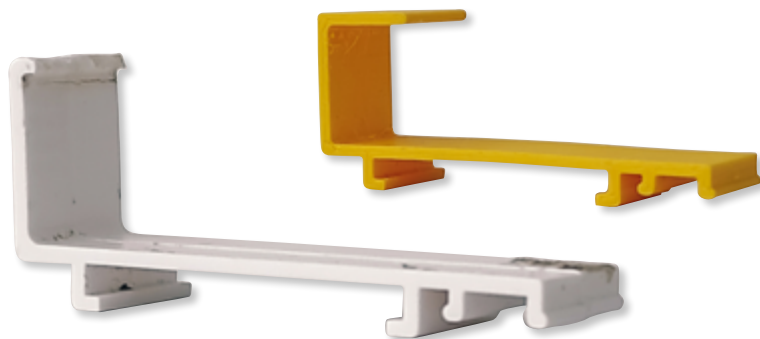
7: Gebrochene Halterung eines Fensterrollos (l.) und gedrucktes Fertigteil (r.)
