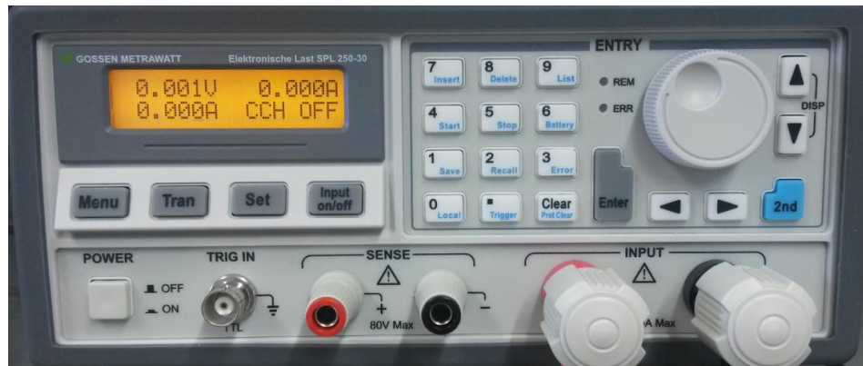
Abb. 2.1: Frontansicht der elektronischen Last SPL 250-30
