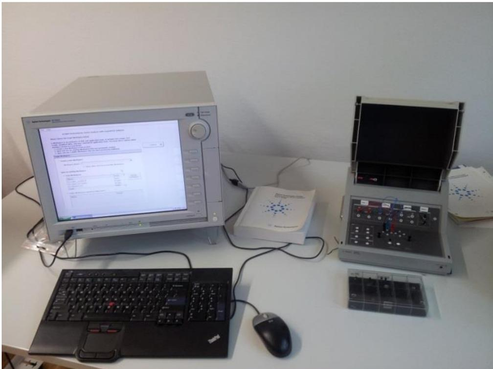
Abbildung 1: Arbeitsplatz zur Parameteranalyse mit Analysator und Test Fixture
