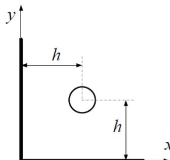
Nach dem Spiegelungsprinzip kann das Potentialfeld im Inneren des dielektrischen Winkels wie folgt beschrieben werden:
