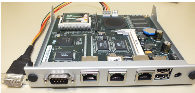
Abb. 9: ALIX Board, Basis für Embedded Implementierungen des SMGW
