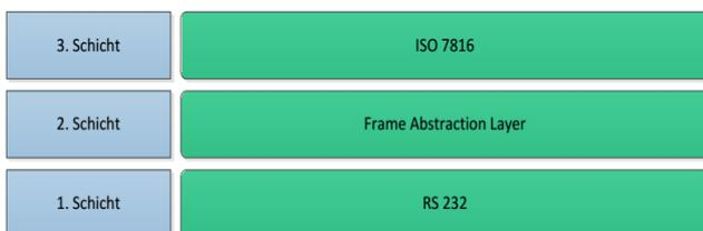
Abb. 7: Kommunikationsschichten der SmartMeteringLib
