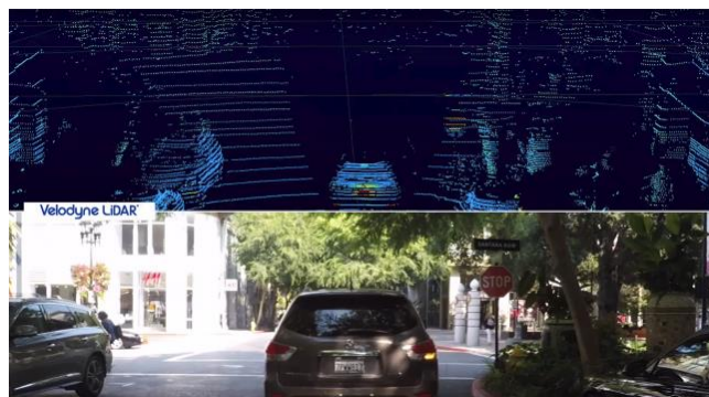
Abbildung 1: Beispielhaft ausgerüstetes Fahrzeug und zu erwartende Daten
