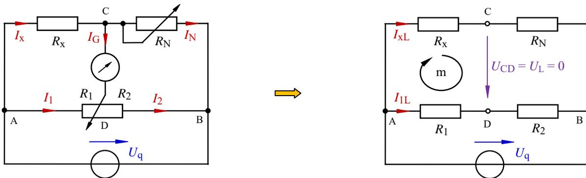
Bild ÜA\_1\_4.4\_1: WHEATSTONESche Brückenschaltung (rechts: abgeglichener Zustand)
