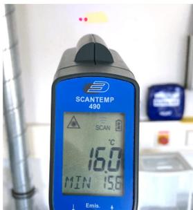
Abbildung 1: Messung der Oberflächentemperatur
